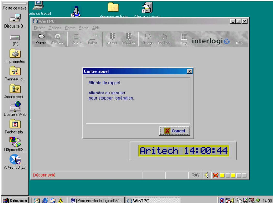
Le PC reçoit l'appel de la centrale. Ne pas appuyer sur la touche d'espace, car le modem va décrocher automatiquement.
